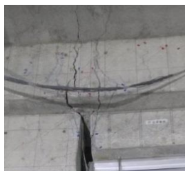
図 5 2F 梁損傷状態 ( R=1/50\text{rad} )
